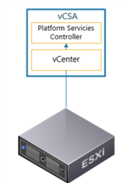
Рис.3 vCenter (vCSA) со встроенным PSC на не принадлежащем ему ESXi-сервере
